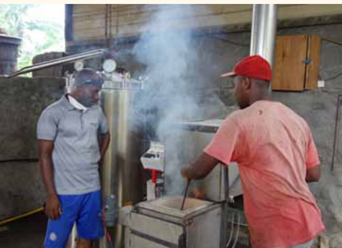
Test du prototype de l'alambic hybride
